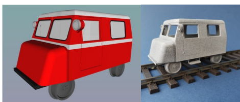
Abb.3) Motordraisine KLV 12 / 3D Konstruktionsstand [Quelle: Rafael Stuck]
