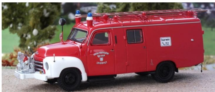
Art.-Nr. 20702: LF8 mit weißen Kotflügeln, weißer Frontstoßstange, am Dach montierten Rundum-Blaulichtern, unter dem Frontfenster montierten Scheibenwischern, hinter den vorderen Seitenfenstern montierten Fahrriechungs-Winkern, Landshuter Kennzeichen und Türbeschriftung als Freiwillige Feuerwehr der Stadt Landshut.
